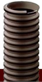
Uso industrial y automotor. Aspiración e impulsión de gases y polvos. Conducción de aire caliente hasta 120°C. Gran flexibilidad. Radios de curvatura exigentes sin colapsado.
